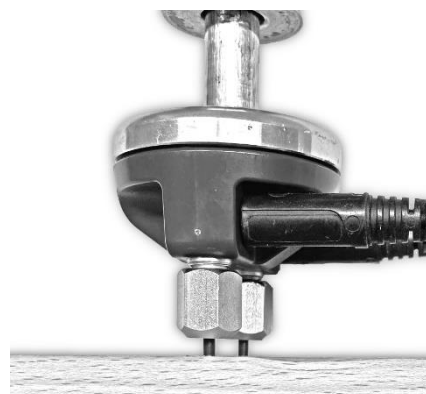
Kuva 9-2: Tefloneristettyjen kärkien käyttö
