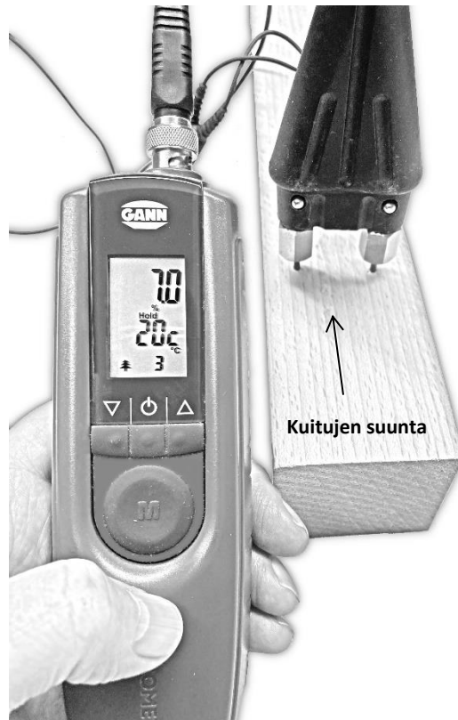
Kuva 9-1: Puun kosteuden mittaus – suorassa kulmassa syiden suuntaan nähden
