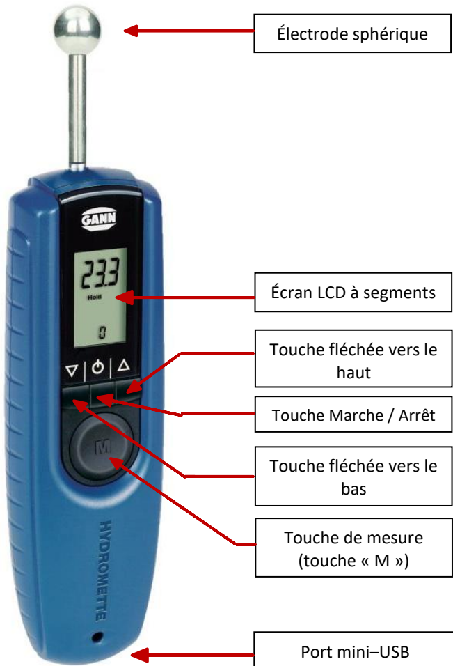
Illustration 2-1: Vue de l'Hydromette BL Compact B 2
