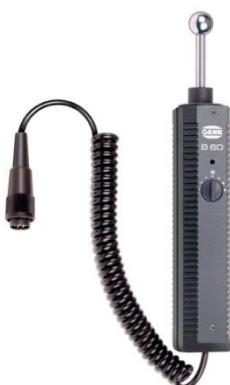
s integriranim mjernim krugom, napravljena za sigurno lociranje koncentracije vlage u građevnim materijalima i distribuciji vlage u zidovima, stropovima i podovima. Rad elektroda zasniva se na patentiranoj mjerenoj proceduri generiranja koncentriranog polja visoke frekvencije u dubinu materijala.
