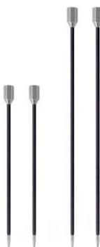
za dubinsko mjerjenje materijala u pozadini (iza ploča), s izoliranim podnožjem (koristi se samo uz elektrodu M 20)
