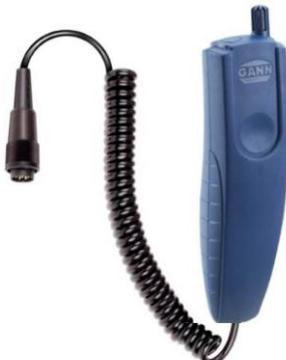
s integriranim mjernim krugom, za mjerena vlage zraka i temperature zraka, kompletna s kablom za spajanje.
