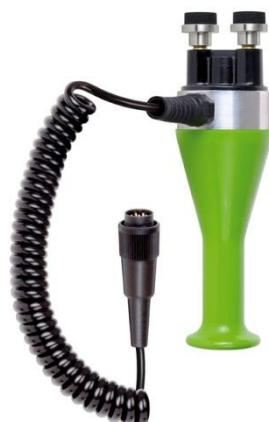
Aktivna elektroda MB 35 razvijena je posebno za površinska mjerena vlage na betonskim i oblogama ispod podova, te je pogodna za provjeru vlage prije nanošenja premaza ili ljepila. Raspon mjerena je od 1.0 do 8.0% suhe težine (prema testu u pećnici). Očitanje se prikazuje u postotcima vlage.
