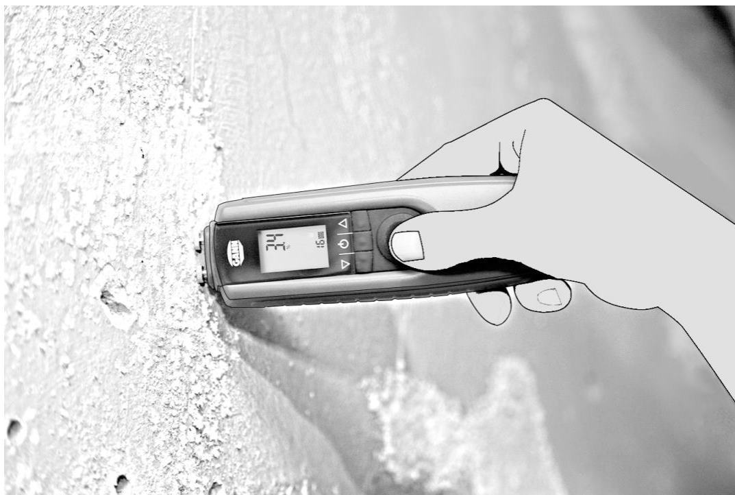
Illustration : Mesure de l'humidité des constructions – Mesure dans de l'enduit
