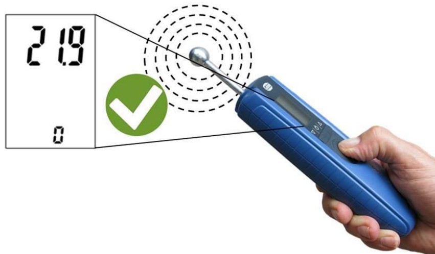
Kuva 9-1: Laitteen oikea asento
