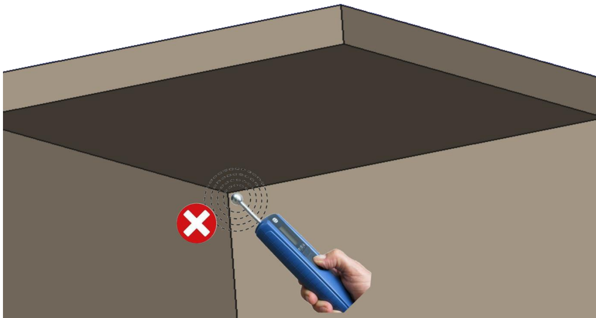
Kuva 9-6: Virheellinen käyttö nurkka-/kulma-alueella
