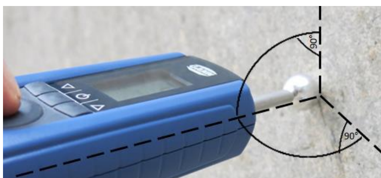
Kuva 9-3: Mittaus mahdollisimman kohtisuorassa mitattavaan pintaan nähden
