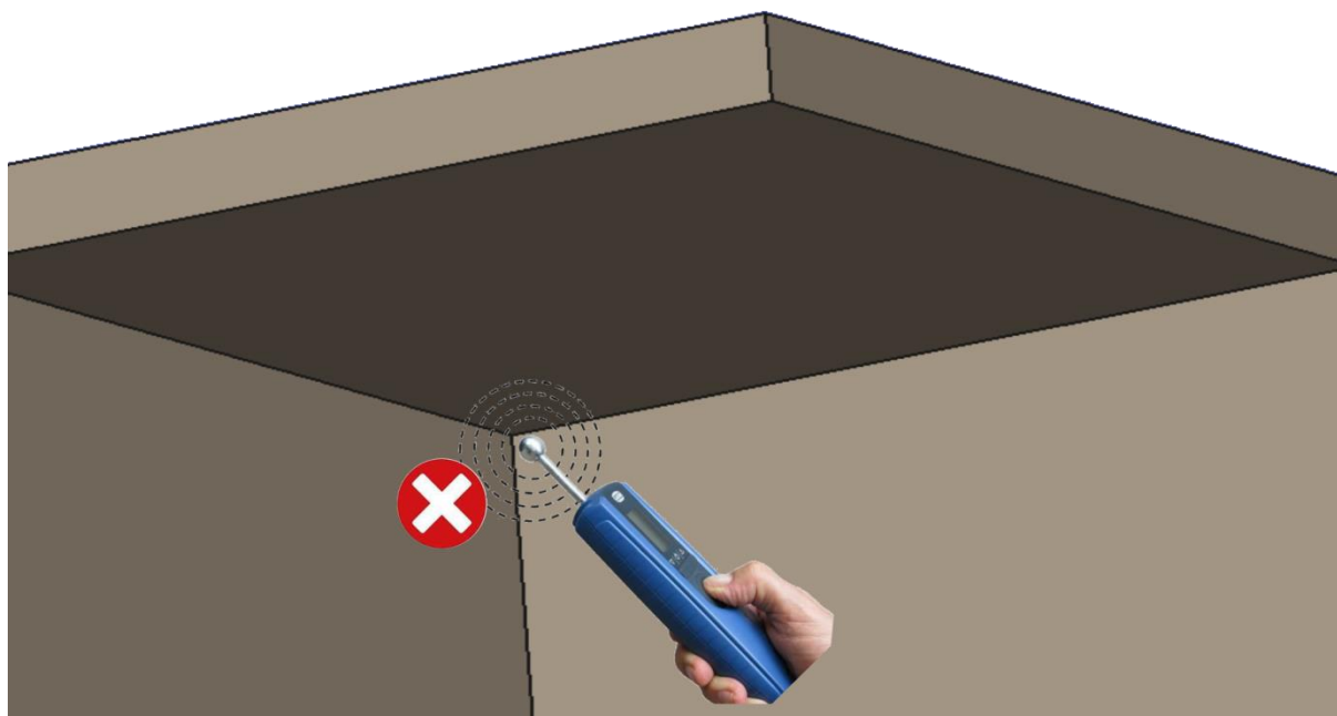
Illustration 9-6 : Mauvaise application dans un coin/angle
