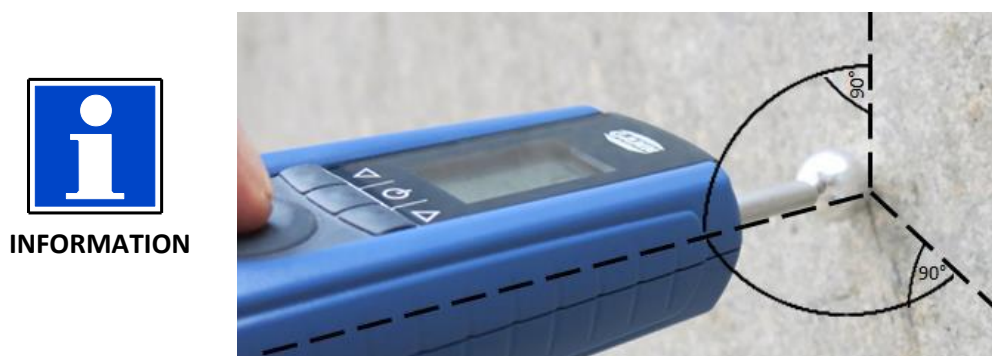
Illustration 9-3 : Mesure à effectuer le plus perpendiculairement possible à la surface de
