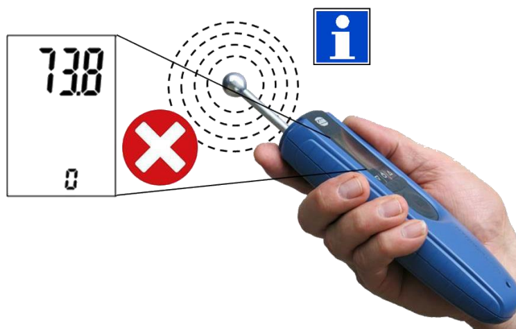
Illustration 9-2 : Mauvaise manière de tenir l'appareil
