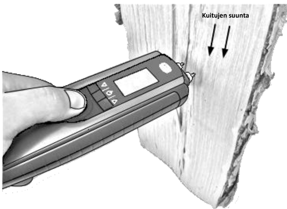
Kuva 7-1: Puun kosteuden mittaus – suorassa kulmassa syiden suuntaan nähden
