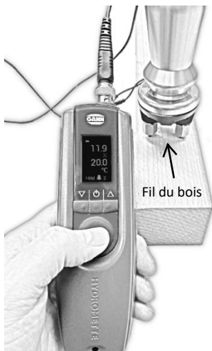
Illustration 3-1 : Mesure de l'humidité du bois – perpendiculairement au fil du bois
