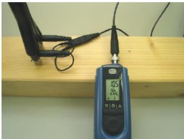
Fig. 4.1 Misura con M20, con chiodi infissi trasversalmente alle fibre del legno
