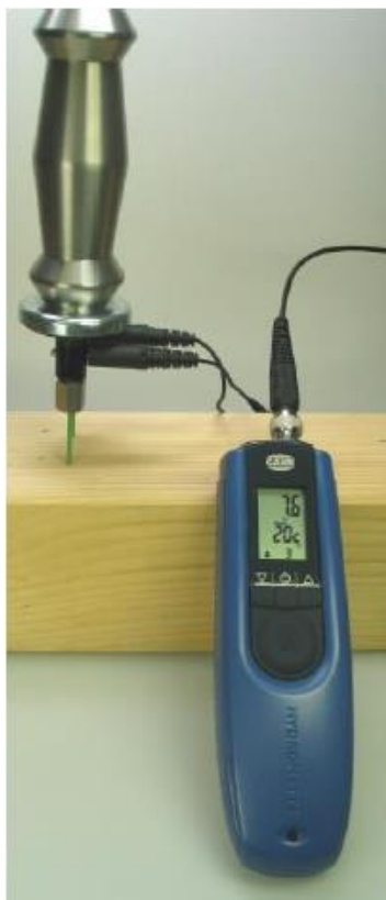
Fig. 4.2 Elettrodo a massa battente M18
