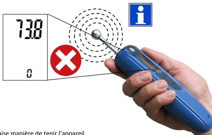
Illustration 13-2 : Mauvaise manière de tenir l'appareil
