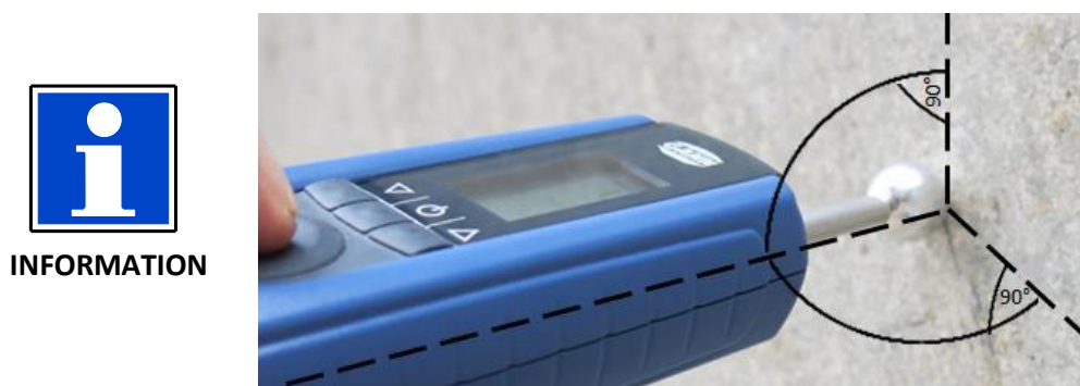
Illustration 13-3 : Mesure à effectuer le plus perpendiculairement possible à la surface de mesure
