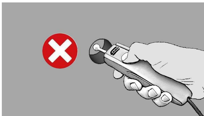
Illustration 9-5 : Application erronée - Mesure dans une forure
