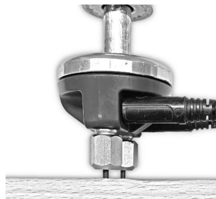
Illustration 9-1 : Utilisation des pointes isolées au téflon
