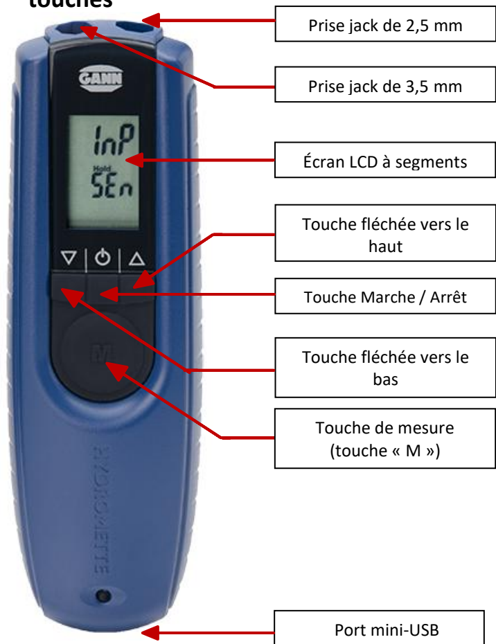
Illustration 2-1 : Vue avant de l'Hydromette BL UNI 11
