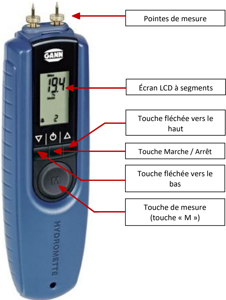
Illustration 2-1: Vue de l'Hydromette BL Compact S
