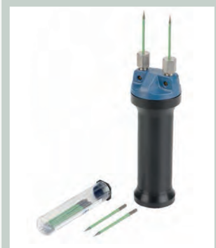
Einstech-Elektrode M 19 mit isolierten Elektroden-Spitzen (60 mm) zur Messung fertig verputzter Wärmedämmverbundsysteme
