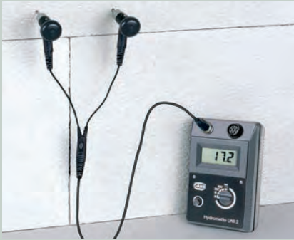
PRAXIS-TIPP Idealer Abstand der Elektroden: 10 cm
