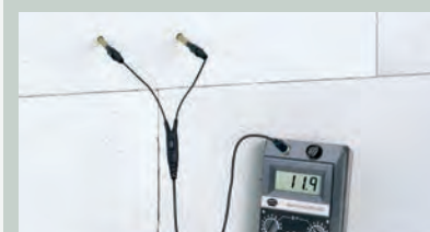
ANWENDUNG Messung mit einem Tiefen-Messelektrodenpaar M 21-250
