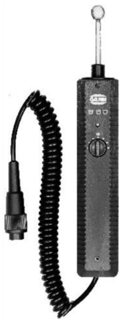
avec circuit de mesure intégré pour détecter de manière non destructive des concentrations d'humidité dans des bâtiments et de la répartition d'humidité dans des murs, des plafonds et des sols. L'électrode fonctionne suivant un procédé de mesure spécial, produit un champ de haute fréquence concentré avec un effet en profondeur importante.
