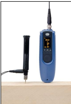
Afbeelding 5-1: Meting loodrecht op de vezelrichting met M 20
