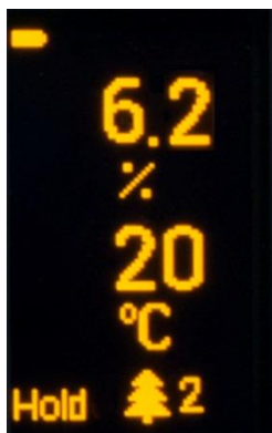
Afbeelding 2-1: Weergave van de op weerstand gebaseerde meting
