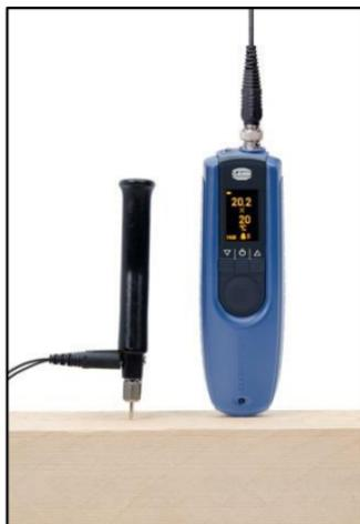
**Figura 5-1: Misurazione trasversale rispetto alla direzione delle fibre con M 20**
