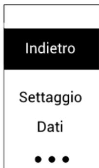
Premendo in modalità stand-by i tasti "Su" o "Giù", si accede al menu principale. I tasti "Su" e "Giù" consentono la navigazione all'interno del menu. La selezione di una voce di menu avviene mediante pressione del tasto di misurazione. I tre puntini presenti sul bordo superiore o inferiore dello schermo indicano la presenza di ulteriori opzioni di selezione, visualizzabili con la funzione di scroll.
