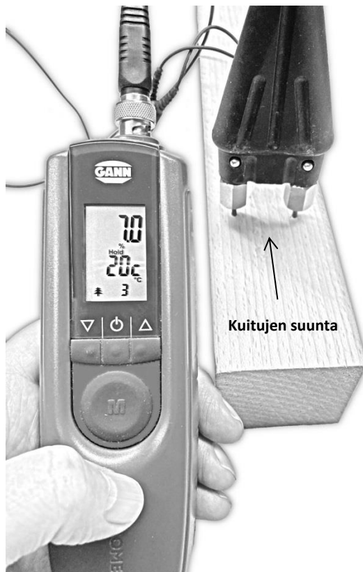
Kuva 7-1: Puun kosteuden mittaus – suorassa kulmassa syiden suuntaan nähden
