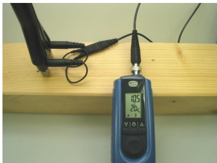
Bild 4-3 Mätning vinkelrätt mot fiberriktningen med M 20
