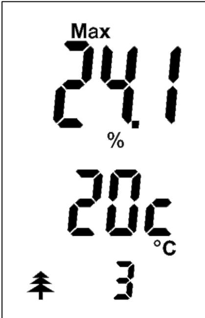
Abbildung 5-10: Maximalwert-Anzeige
