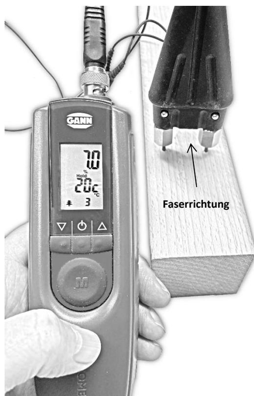
Abbildung 7-1: Holzfeuchtemessung – quer zur Faserrichtung
