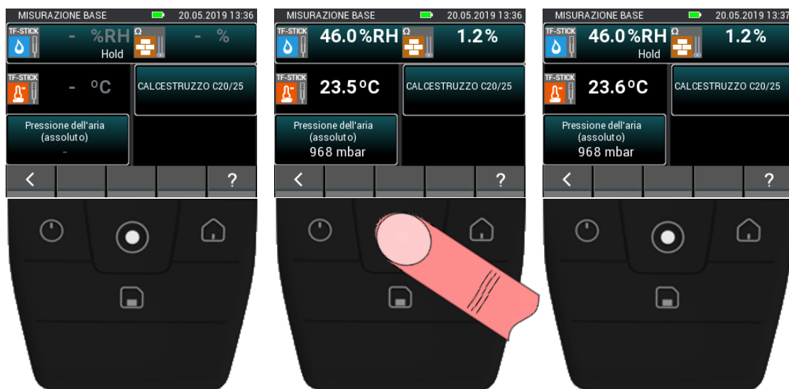
Figura 4-5: Processo di misurazione della misurazione di base
