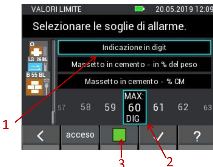
Figura 3-24: Menu per l'impostazione dei valori soglia per materiali diversi all'impiego della sonda B55 BL
