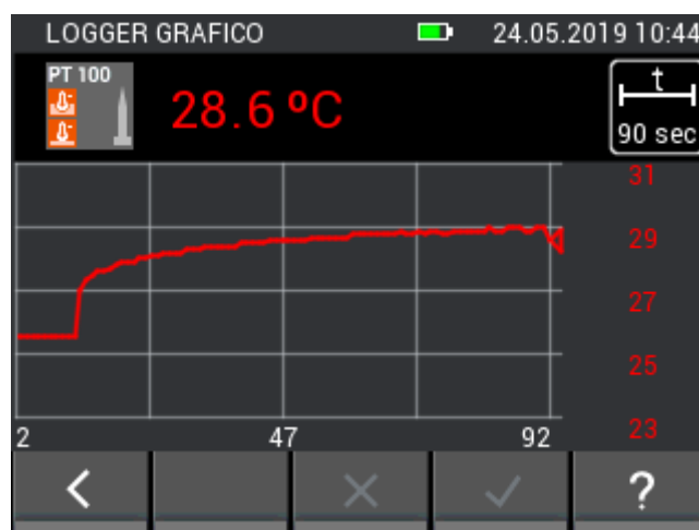
Figura 12-15: Misurazione logger grafico con sonda PT100 BL
