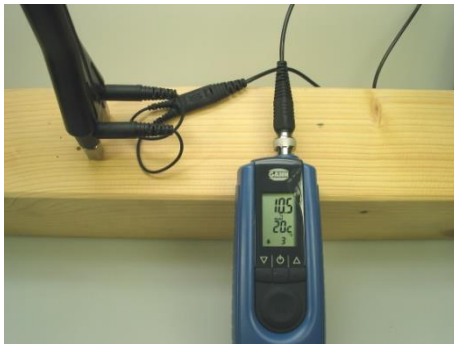
Abbildung 4-1 Messung quer zur Faserrichtung mit M 20
